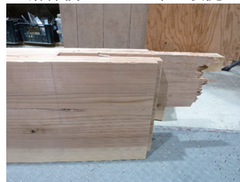
解体後・NO.2の竿の破断
