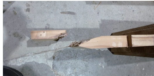
解体後・NO.2の竿の破断
