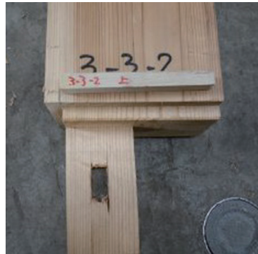
解体後・NO.2 の破壊性状
