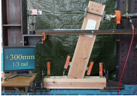
試験体 NO.1 の水平変位 300mm (1/3rad) 時の様子
