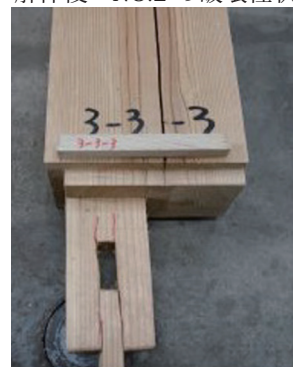
解体後・NO.3 の破壊性状
