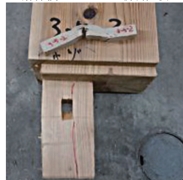
解体後・NO.2 の破壊性状
