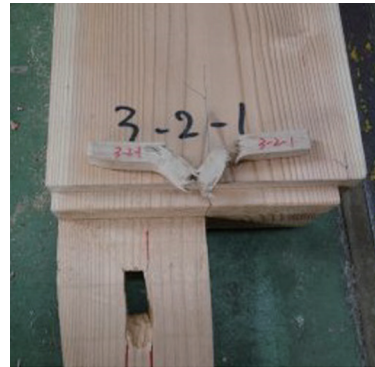
解体後・NO.1 の破壊性状
