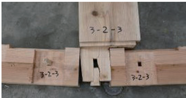
解体後・NO.3 の破壊性状
