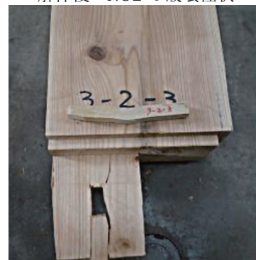
解体後・NO.3 の破壊性状
