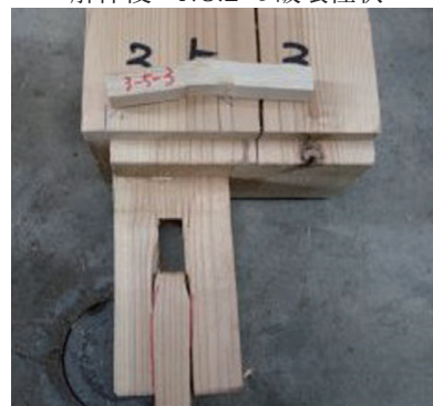
解体後・NO.3 の破壊性状
