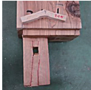
解体後・NO.01 の破壊性状
