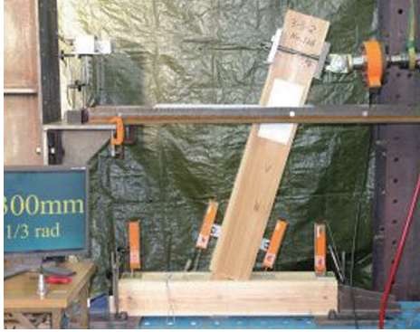
試験体 NO.2 水平変位 300mm (1/3rad) 時の様子
