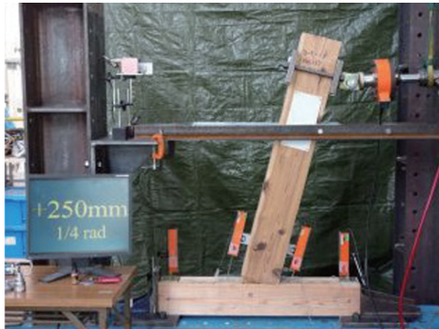
試験体 NO.1 の水平変位 268mm 時の様子
