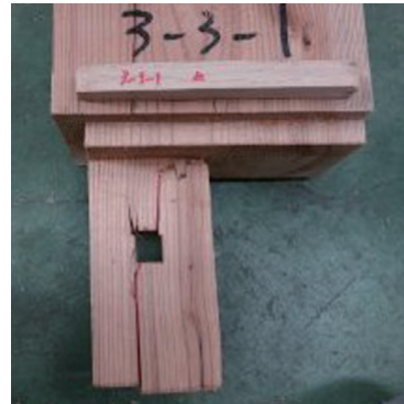
解体後・NO.1 の破壊性状
