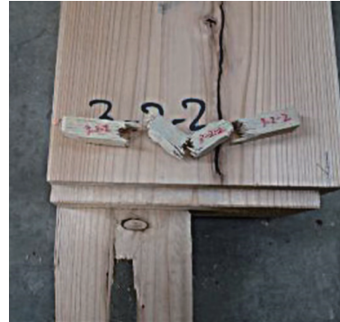
解体後・NO.2 の破壊性状
