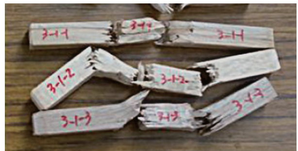
込み栓の様子
