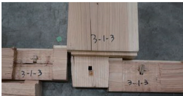
解体後・NO.3 の破壊状況
