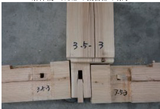
解体後・NO.3 の接合部の様子
