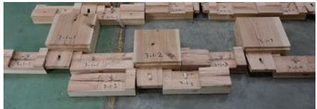
解体後・接合部の様子
