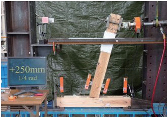
試験体 NO.1 の水平変位 250mm (1/4rad) 時の様子
