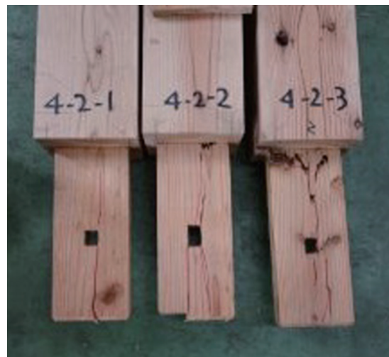
解体後・ほぞの破壊状況
