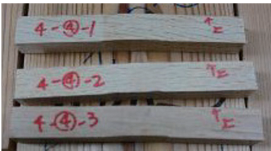
解体後・込み栓の様子
