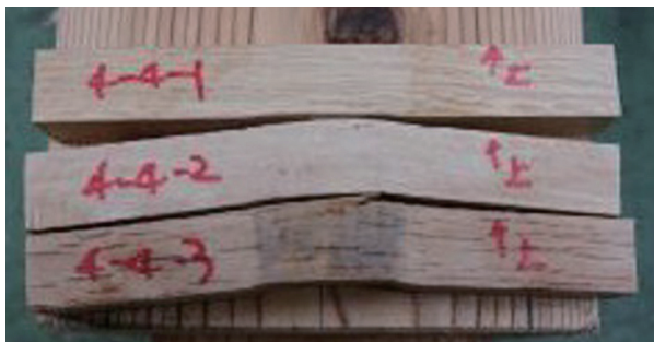
解体後・込み栓の様子
