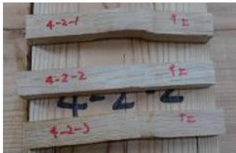
解体後・込み栓の様子
