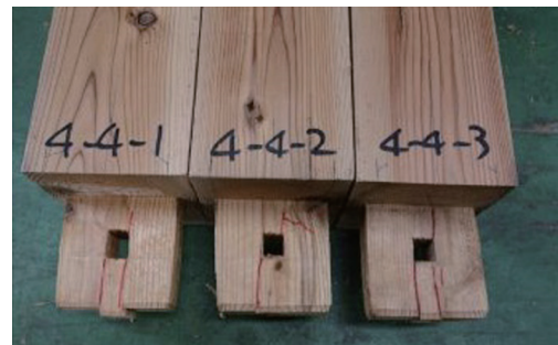
解体後・ほぞの破壊状況
