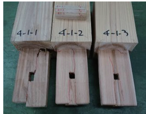
解体後・ほぞの破壊状況
