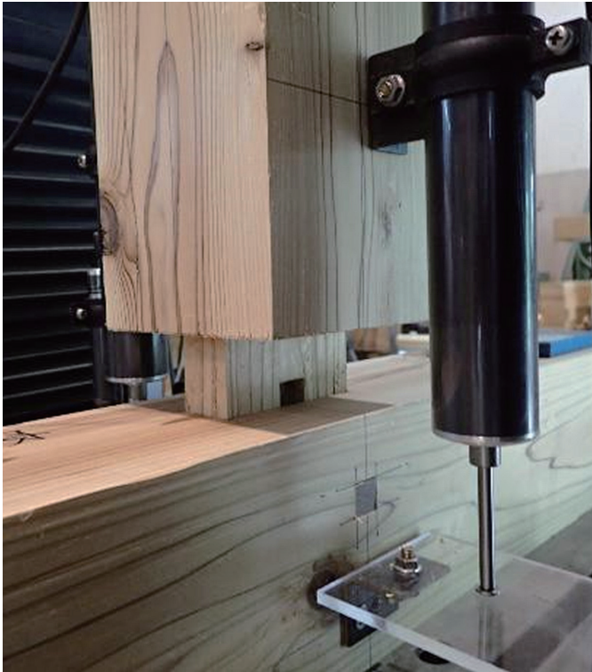
ほぞの引き抜け
