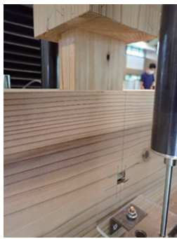
ほぞの引き抜け
