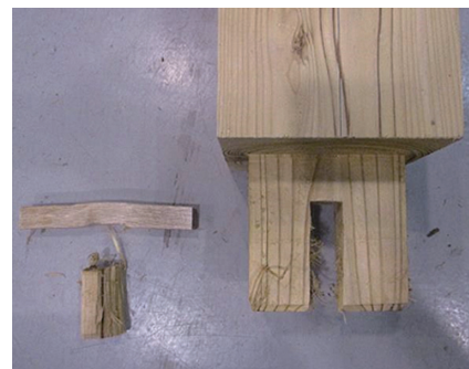
解体後・NO.1 曲げ変形した込み栓とせん断破壊したほぞ
