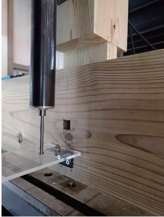
ほぞの引き抜け
