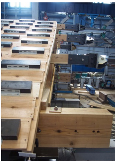
写真 1 野地板のズレと垂木のねじれ
