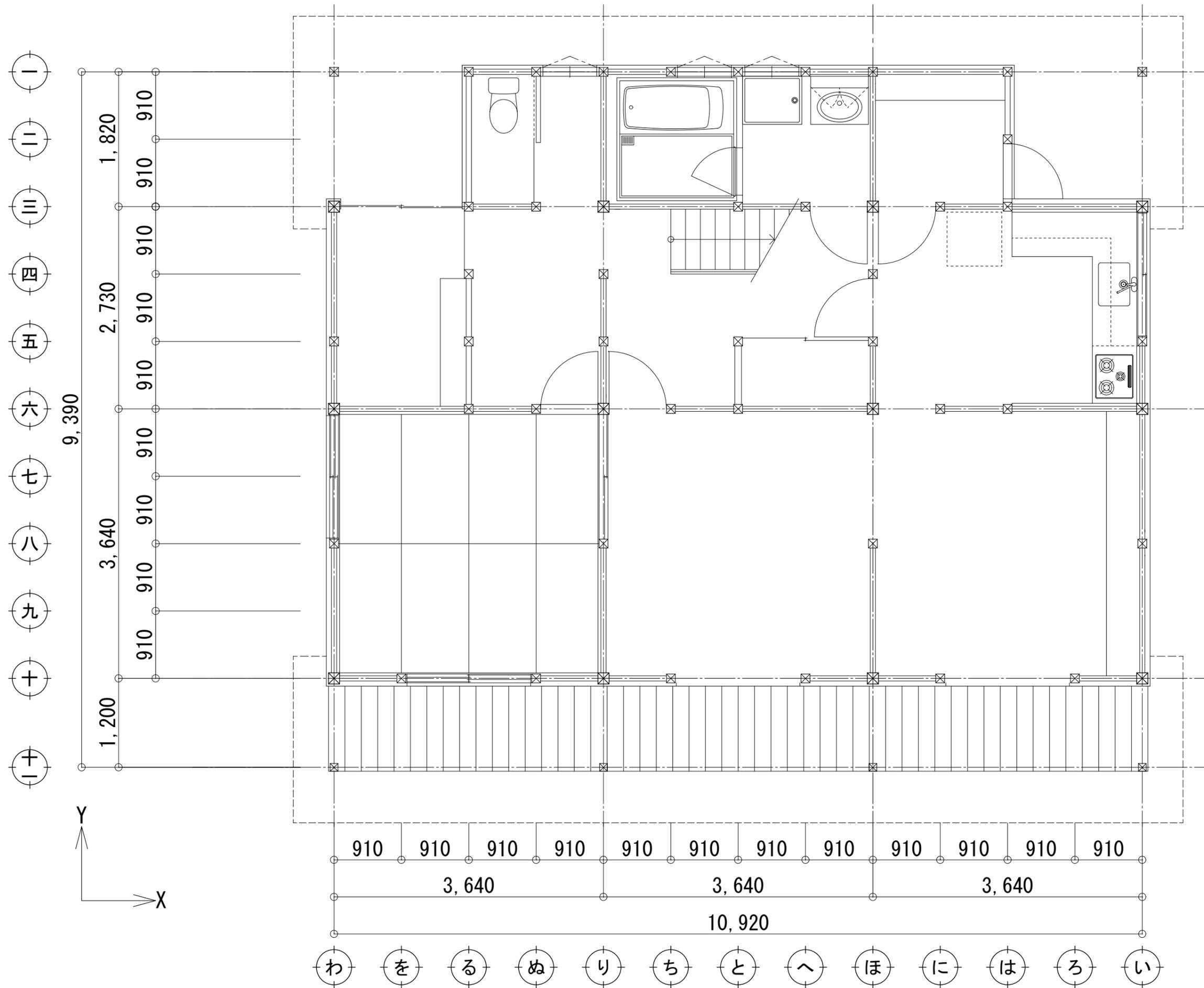
1階平面図 (A3で印刷した場合 1/50)
